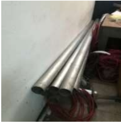
TUBERÍA 3 PULGADAS MATRIZ ELÉCTRICA PRINCIPAL
